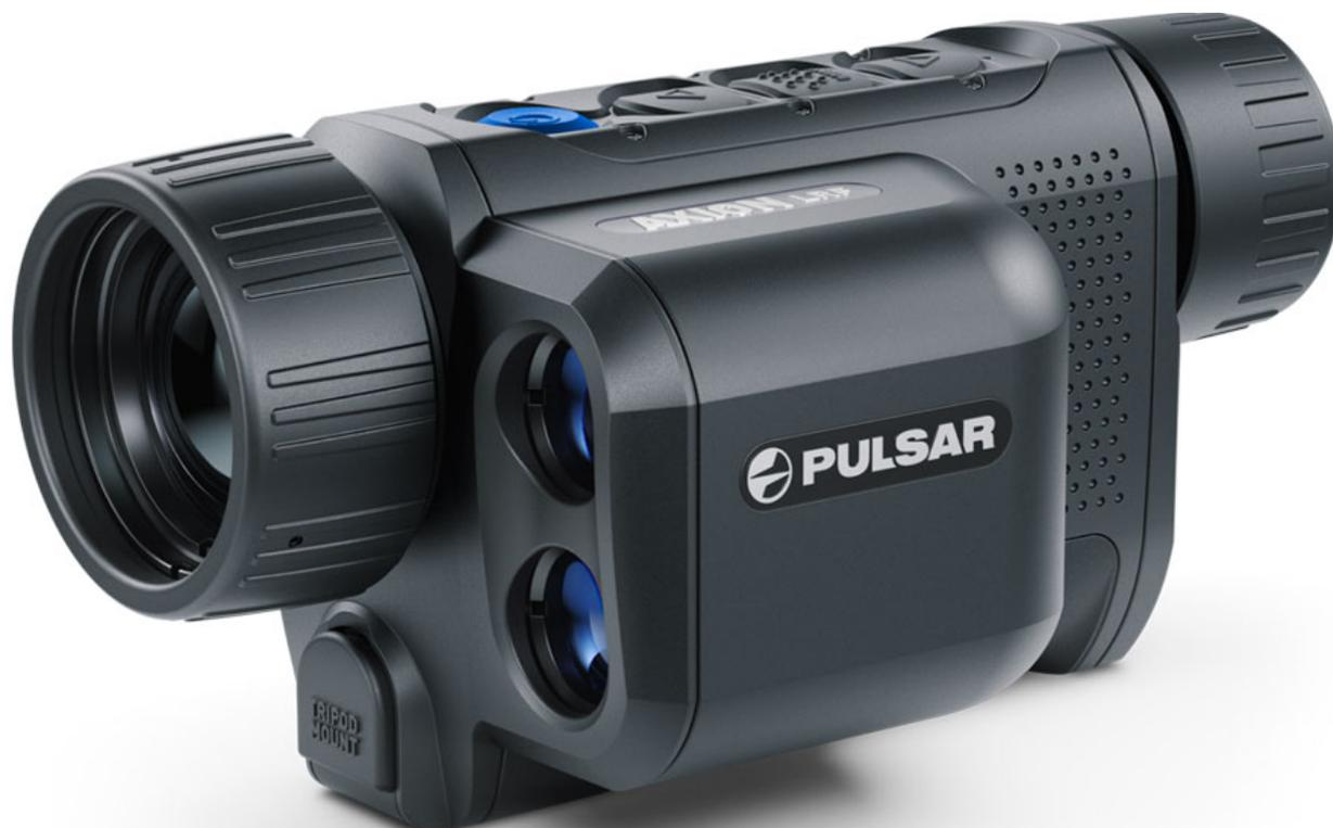
Вы только представьте суть этого симбиоза: при размерах всего 167x74x73 мм и массе 400 граммов, этот крохотный прибор имеет матрицу размером 384x288 пикселей! При этом размер самих пикселей - 17 мкм вместо прежних 12 мкм. Диаметр германиевого объектива - внушительные 38 мм. Всё вместе это даёт высокую чувствительность сенсора и шикарную детализацию «картинки» на любой кратности.
